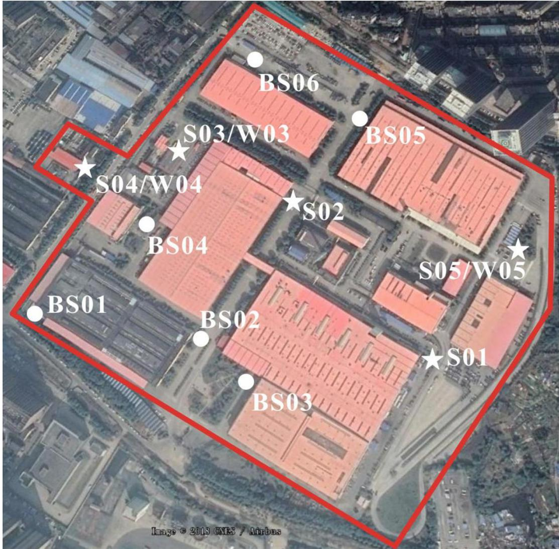
图 3-1 深层土壤采样点（S）、表层土壤采样点（BS）和地下水监测点(W)
